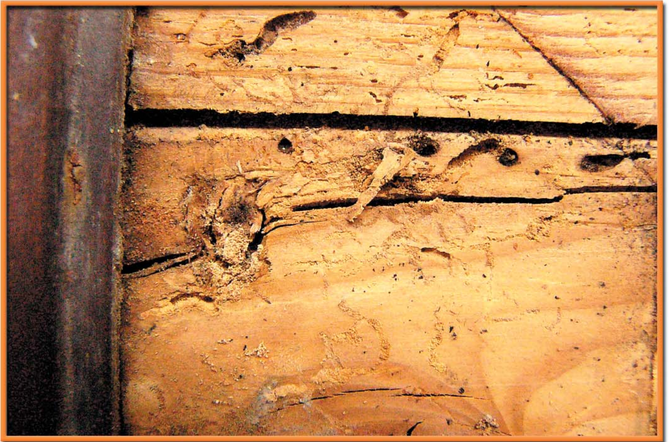
Praskliny korpusu způsobily odlupování dýh a lišt.
