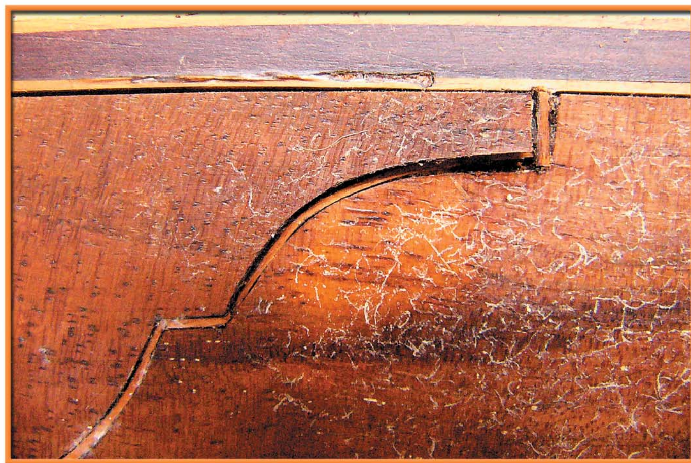
Vzednutí dýhy bylo způsobeno zatopením chodbiček červotoče, které byly těsně pod povrchem.
