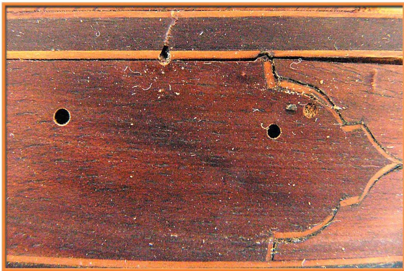
Ostrý pilovitý okraj výletového otvoru svědčí o čerstvém napadení dřevokazným hmyzem. Velikost a tvar je typická pro červotoče.
