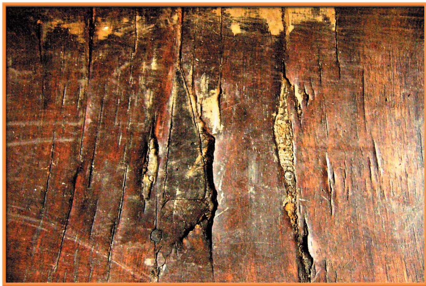
Dýha na akroterii byla místy probroušena na korpus a již v minulosti opravována.
