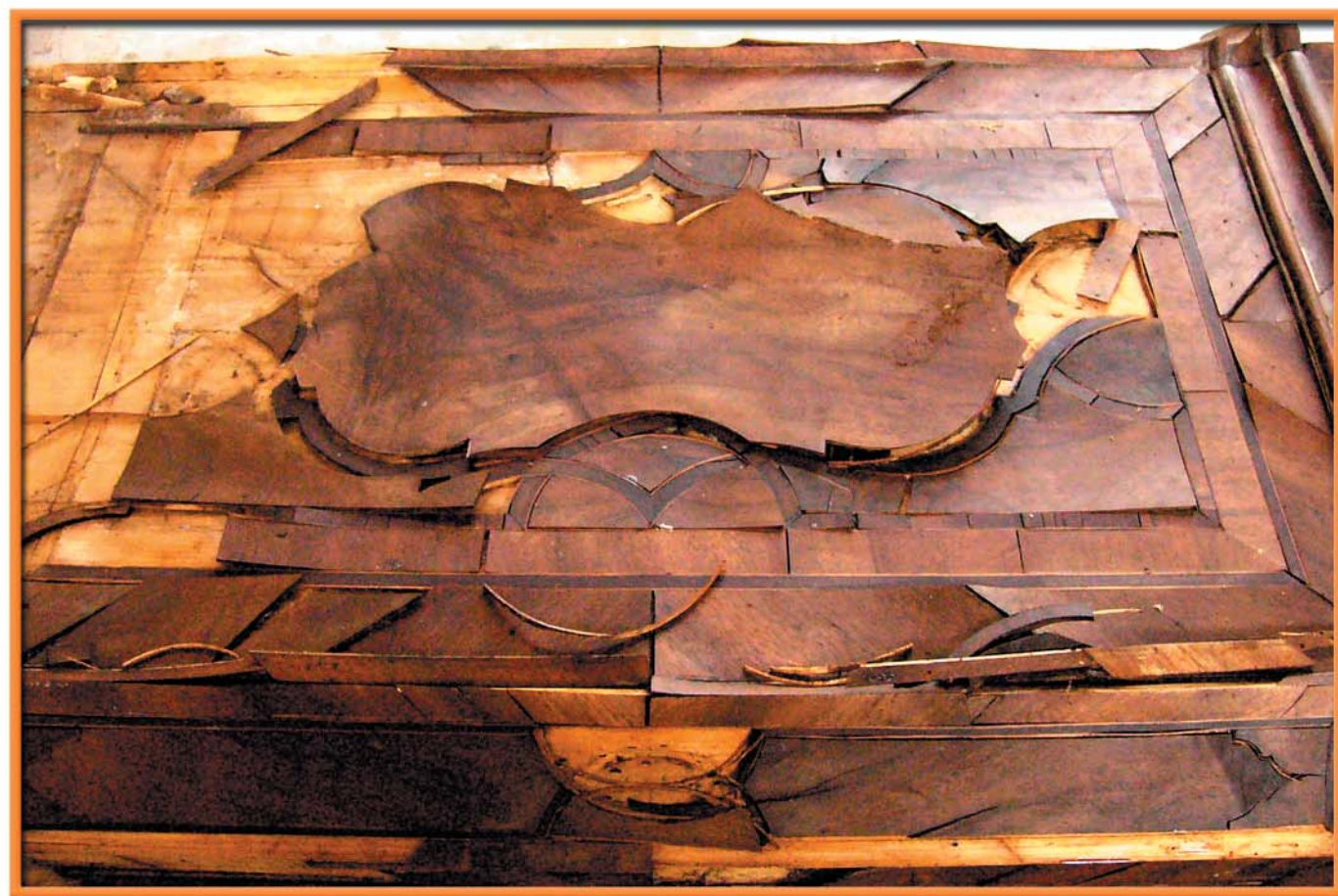
Prohnutí a smrštění intarsie spodní výplně.
