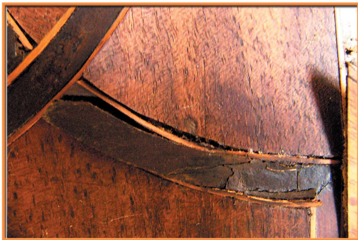
Viditelné póry ve dřevě dokládají, že povrch nebyl zaleštěván politurou.
